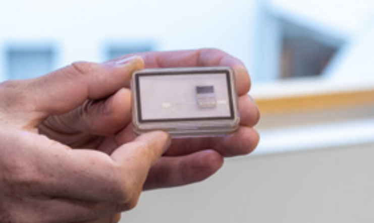
Mikroelektrodenarray im Package mit Leiterplatte und Stecker zum elektrischen Anschluss
